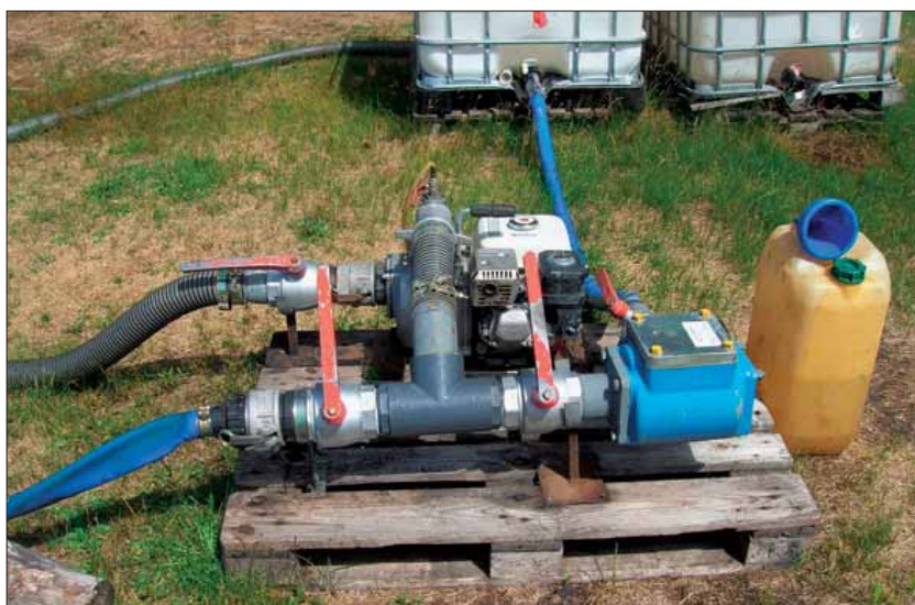
Ryc. 46. Pompa ssąco-tłocząca do mieszania cieczy użytkowej i tankowania statku powietrznego (fot. S. Majewski)
