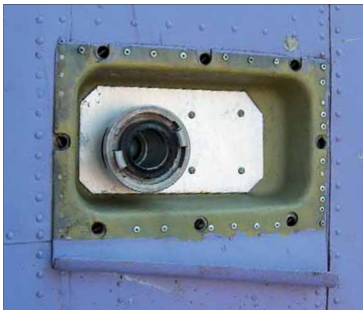
Ryc. 47. Zawór do tankowania cieczy użytkowej do samolotu An-2R (fot. S. Majewski)
